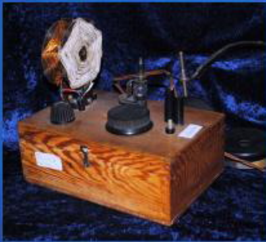
Detektor-Radio 1915 - spielte ohne Strom
