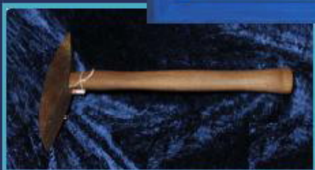
Hammer zum Schärfen des Mahlsteins aus der Mühle Kramer in Obervellmar
