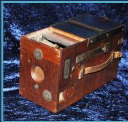
Detektor-Radio 1915 - spielte ohne Strom
